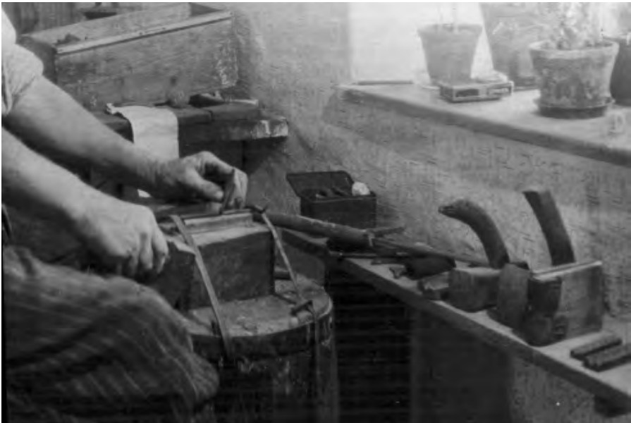
Pracovní prostor pilníkáře při výseku pilníkového zuby, Křížánky. 50. léta 20. století. Archiv Souboru lidových staveb Vysočina Hlinsko.
